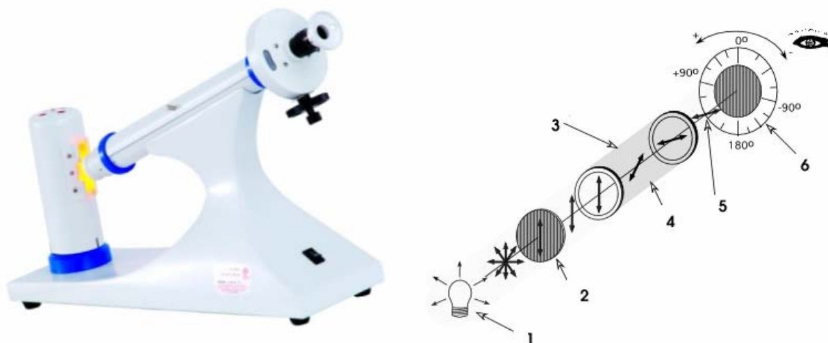
Fig 3 - Fotografia de um polarímetro de disco (esquerda). Esquema interno de um polarímetro (direita).
