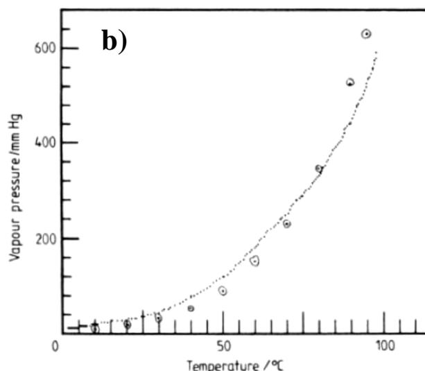
Fig. a) Pressão de vapor de diversos líquidos em função da temperatura (Mbeychok M., 2007 Wikipedia). b) Pressão de vapor da água em função da temperatura (Fox J. N., 1993 Phys. Educ. 28 190)
