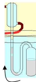
C) A medida que a temperatura do banho desce as bolhas vão parar de fluir e líquido no tubo U irá se equilibrar. Nesse momento anote a pressão e a temperatura. Note que quando os níveis do líquido nos dois ramos do tubo em U são iguais, a pressão do gás no interior do balão é igual a pressão do gás dentro do condensador (e na tubulação acima deste). Este valor difere da pressão atmosférica exatamente pela diferença de altura nos níveis de mercúrio do manômetro.
