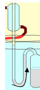
E) Para re-equilibrar o nível do líquido no tubo U abra a válvula 2 (**LENTAMENTE**) para diminuir a pressão do sistema. Anote a temperatura e a pressão no manômetro de mercúrio ( $\Delta H$ ).
