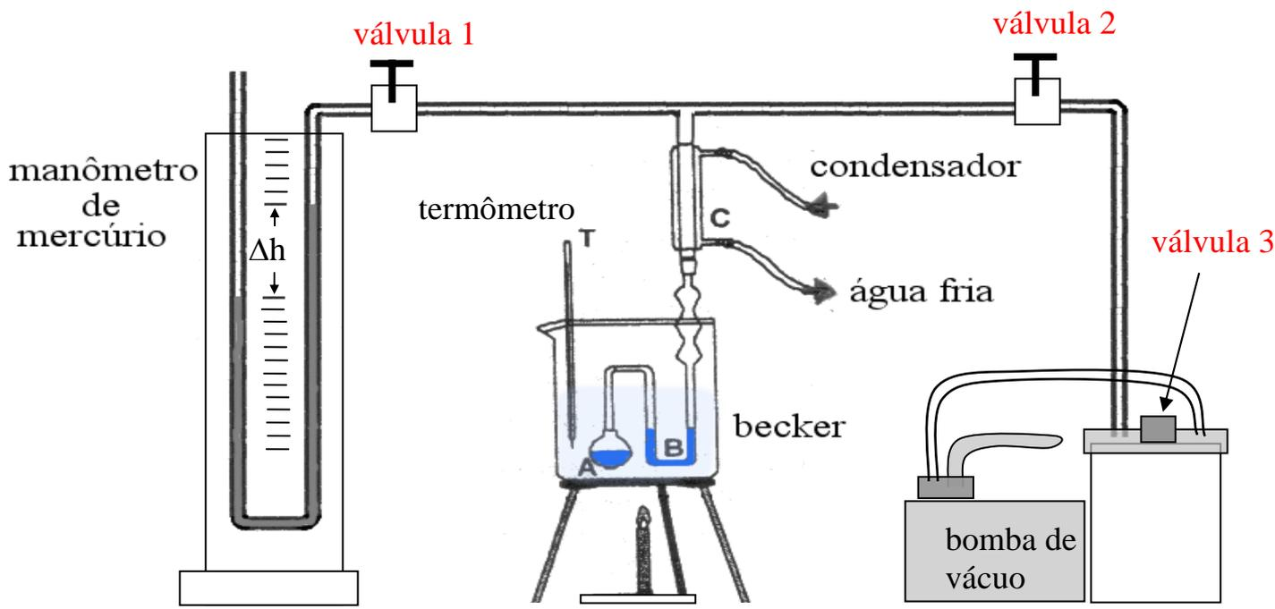
**Válvula 1** – Isola o manômetro de mercúrio do sistema que contém a amostra.
