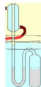
D) **Importante.** NÃO deixe o líquido no tubo U ficar demasiadamente localizado na região próxima ao balão pois bolhas de vapor seguirão na direção ao balão prejudicando a medida. Caso isso aconteça o procedimento inteiro deveria ser reiniciado.
