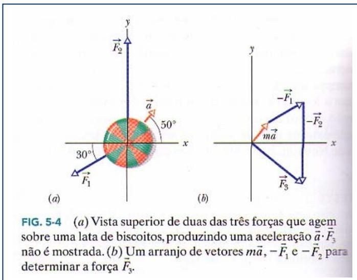
**FIG. 5-4** (a) Vista superior de duas das três forças que agem sobre uma lata de biscoitos, produzindo uma aceleração  $\vec{a}$ .  $\vec{F}_3$  não é mostrada. (b) Um arranjo de vetores  $m\vec{a}$ ,  $-\vec{F}_1$  e  $-\vec{F}_2$  para determinar a força  $\vec{F}_3$ .
