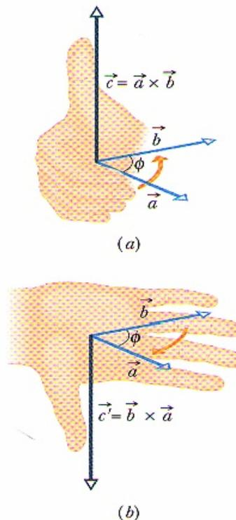
FIG. 3-21 Ilustração da regra da mão direita para produtos vetoriais. (a) Empurre o vetor  $\vec{a}$  na direção do vetor  $\vec{b}$  com os dedos da mão direita. O polegar estendido mostra a orientação do vetor  $\vec{c} = \vec{a} \times \vec{b}$ . (b) O vetor  $\vec{b} \times \vec{a}$  tem o sentido oposto ao de  $\vec{a} \times \vec{b}$ .
