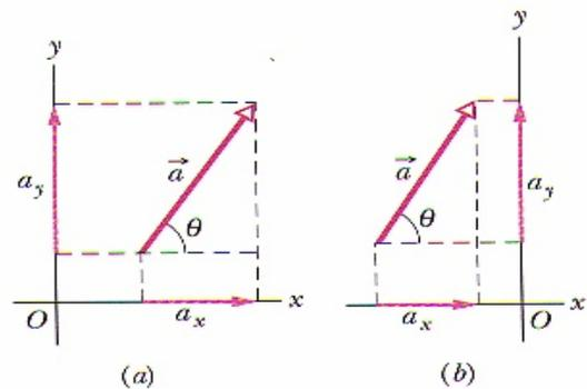
FIG. 3-8 (a) As componentes  $a_x$  e  $a_y$  do vetor  $\vec{a}$ . (b) As componentes não mudam quando o vetor é deslocado, desde que o módulo e a orientação sejam mantidos.
