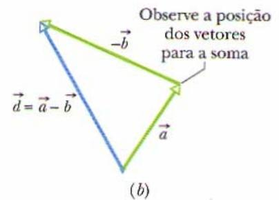
FIG. 3-6 (a) Os vetores  $\vec{a}$ ,  $\vec{b}$  e  $-\vec{b}$ . (b) Para subtrair o vetor  $\vec{b}$  do vetor  $\vec{a}$ , basta somar o vetor  $-\vec{b}$  ao vetor  $\vec{a}$ .
