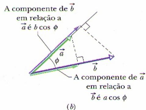
**FIG. 3-20** (a) Dois vetores,  $\vec{a}$  e  $\vec{b}$ , formando um ângulo  $\phi$ . (b) Cada vetor tem uma componente na direção do outro vetor.
