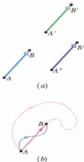
**FIG. 3-1** (a) As três setas têm o mesmo módulo e orientação e, portanto, representam o mesmo deslocamento. (b) As três trajetórias que unem os dois pontos correspondem ao mesmo vetor deslocamento.
