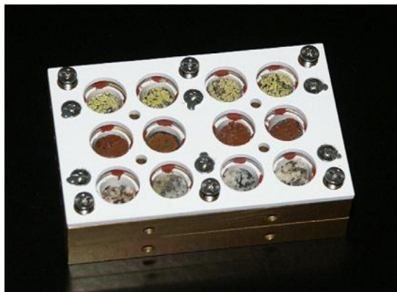
Figura 14.9: Porta amostras do Biopan com vários líquens, dentre eles o Rhizocarpon geographicum (verde). Fonte: Noetzel et al [5].
