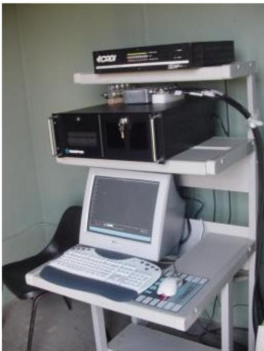
Figura 3.4: Ionossonda Digital tipo CADI. Fonte: Retirada da dissertação de Oliveira (2007)
