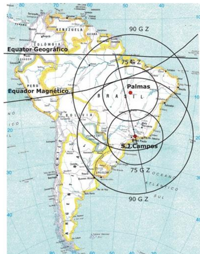
Figura 5.5 - Mapa da América do Sul ilustrando a área de cobertura das imagens do fotômetro operando no Campus do Urbanova em São José dos Campos - SP ( 23,21^{\circ}\text{S} ; 45,86^{\circ}\text{O} ; dip latitude 18,95^{\circ}\text{S} ) e Palmas - TO ( 10,28^{\circ}\text{S} ; 48,33^{\circ}\text{O} ; dip latitude 6,65^{\circ}\text{S} ), para os ângulos zenitais de 90^{\circ} e 75^{\circ}
