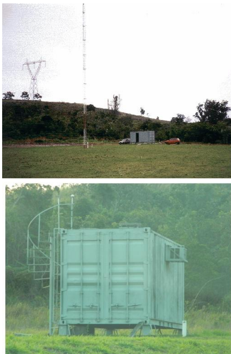
Figura 5.9 - Vista do Laboratório de Antenas 1 - Ionossonda no Campus Urbanova da UNIVAP em São José dos Campos ( 23,21^{\circ}S, 45,86^{\circ}O ) onde opera uma ionossonda digital CADI. Figura superior mastro de sustentação das antenas delta verticais de transmissão e recepção, figura inferior vista do container onde opera o equipamento da ionossonda digital e de um receptor de GPS.
