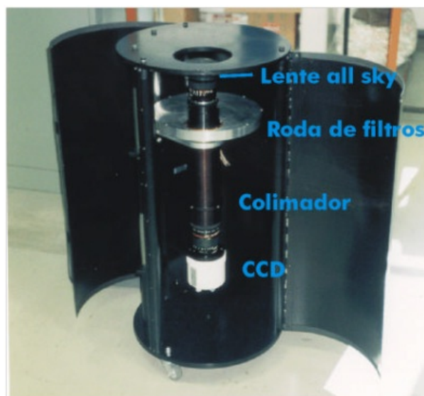
Figura 5.3 - Vista do fotômetro imageador aberto, utilizado pelo Grupo de Física e Astronomia da UNIVAP.
