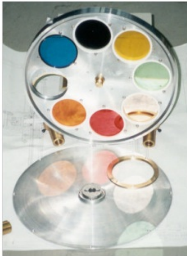
Figura 5.2 - Vista interna da roda de filtros dos fotômetros imageadores da UNIVAP.
