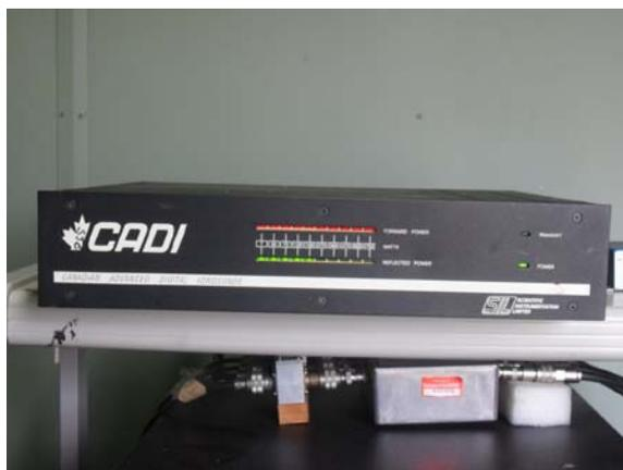
**Figura 3. 10 - Sistema de transmissão CADI para amplificação dos sinais de rádio utilizado pelo grupo de Física e Astronomia da UNIVAP.**
