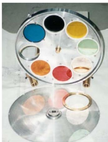
**Figura 3. 3 - Roda de filtros de interferência do Imageador CCD All Sky.**
