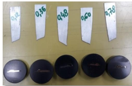
Figura 23: Corpos de provas, embutidos na baquelite, para verificação da dureza.
