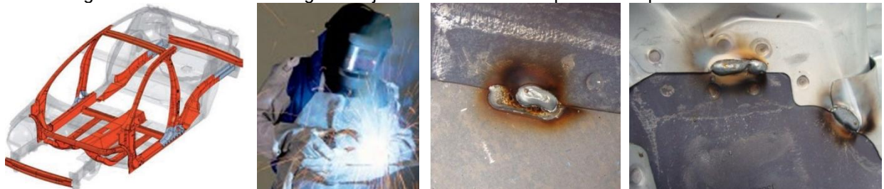
Figura 1: Processo de soldagem de juntas entre duas chapas e o respectivo retrabalho.
