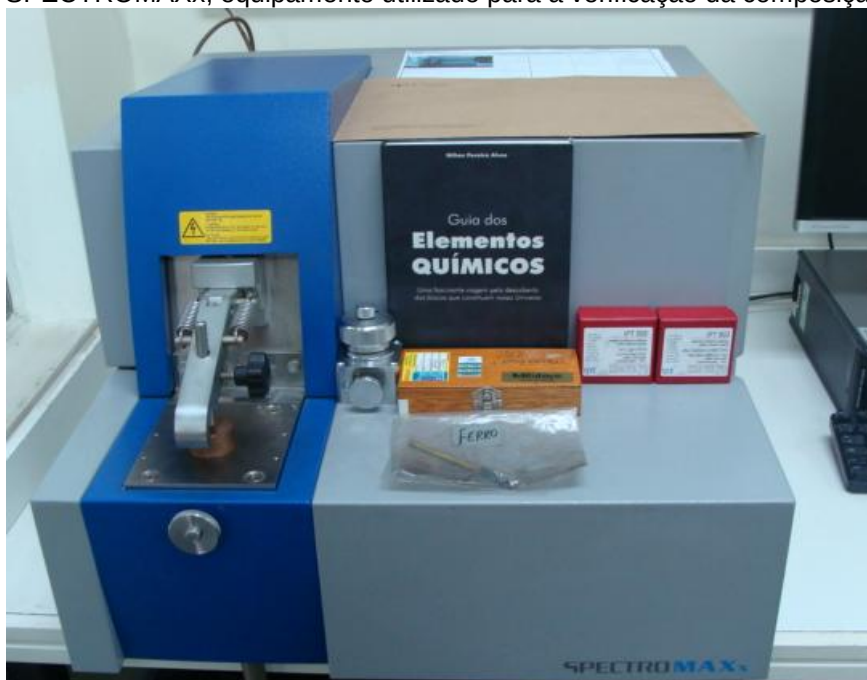
Figura 13: SPECTROMAXx, equipamento utilizado para a verificação da composição química.
