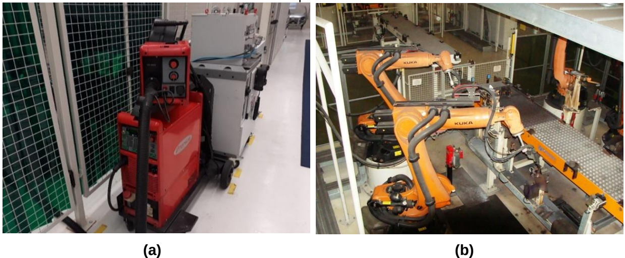
Figura 19: Equipamento de soldagem Fronius (a), e em (b) o Robô usado para soldagem dos corpos de prova.
