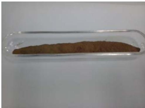
**Figura 24:** Catalisador não moldado após calcinação com fluxo de  $N_2$ .
