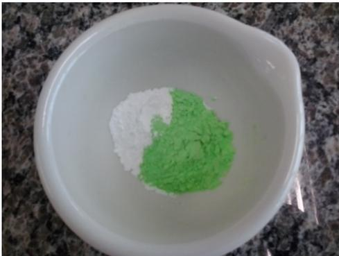
**Figura 26:** Alíquotas de material do LOTE1 + hidróxido precursor de alumina (selecionados  $\phi \leq 0.038\text{mm}$ ) na proporção 80% e 20% após a maceração.
