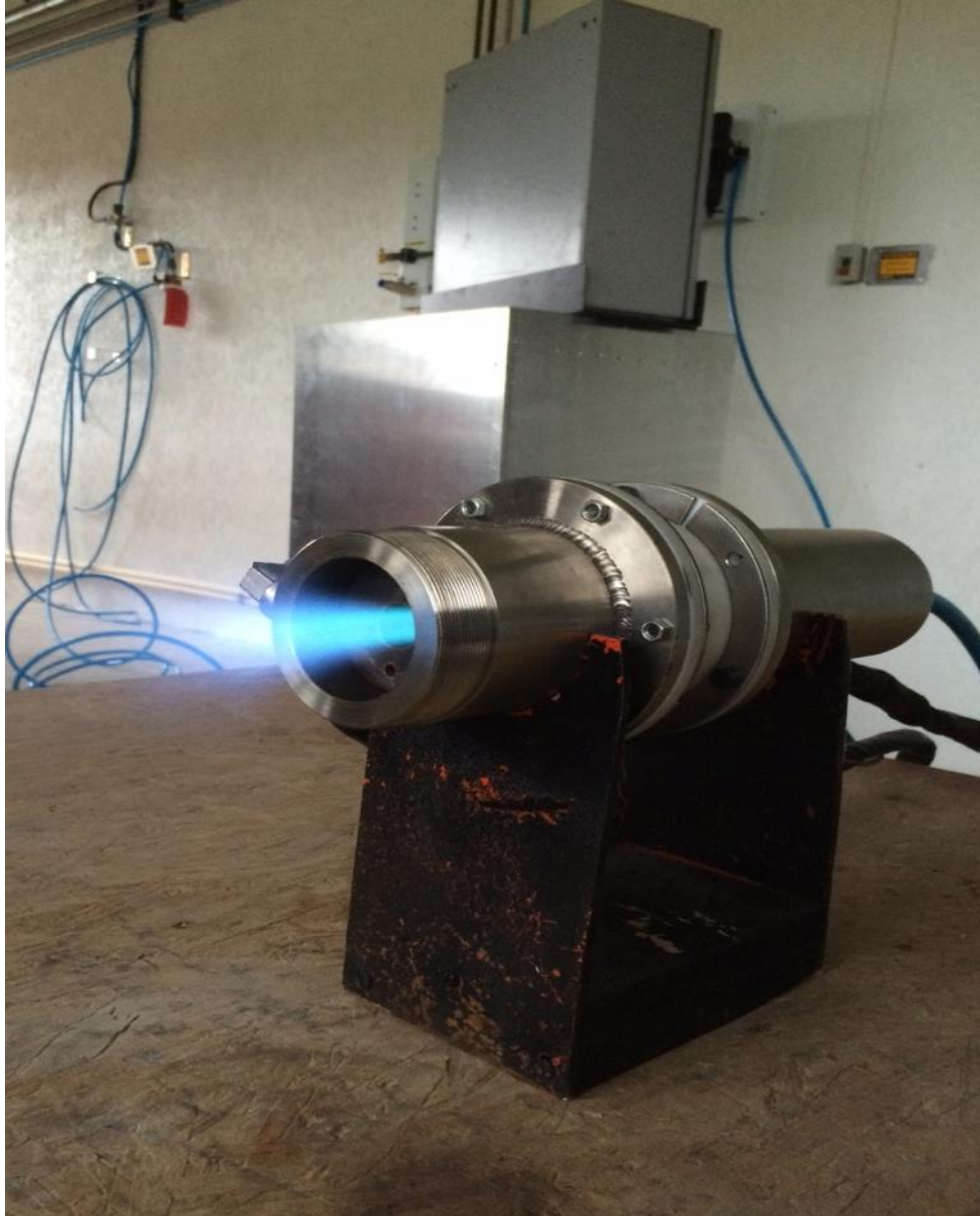
Figura 12 - Foto ilustrando a tocha de plasma tipo “gliding arc” em funcionamento.
