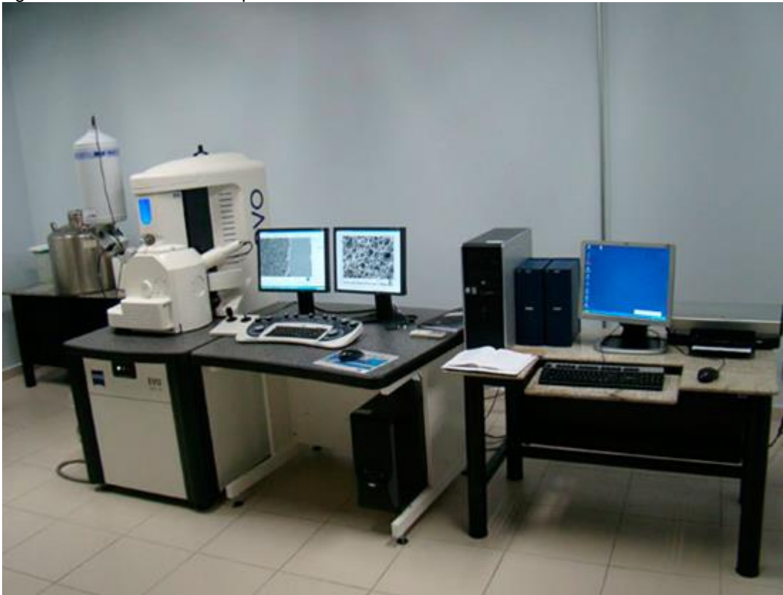
Figura 18 - Foto do microscópio eletrônico de varredura e sistema EDS.
