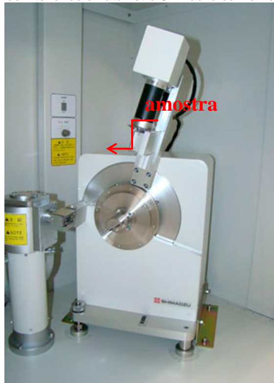
Figura 17 - Foto do interior do difratômetro Shimadzu com amostra posicionada.
