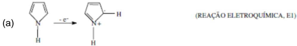
Em geral, a reação pode ser descrita pelos passos da figura 1, inicialmente ocorre a formação do cátion radical a partir da oxidação do monômero no potencial  $E_1$  (figura 1a).
