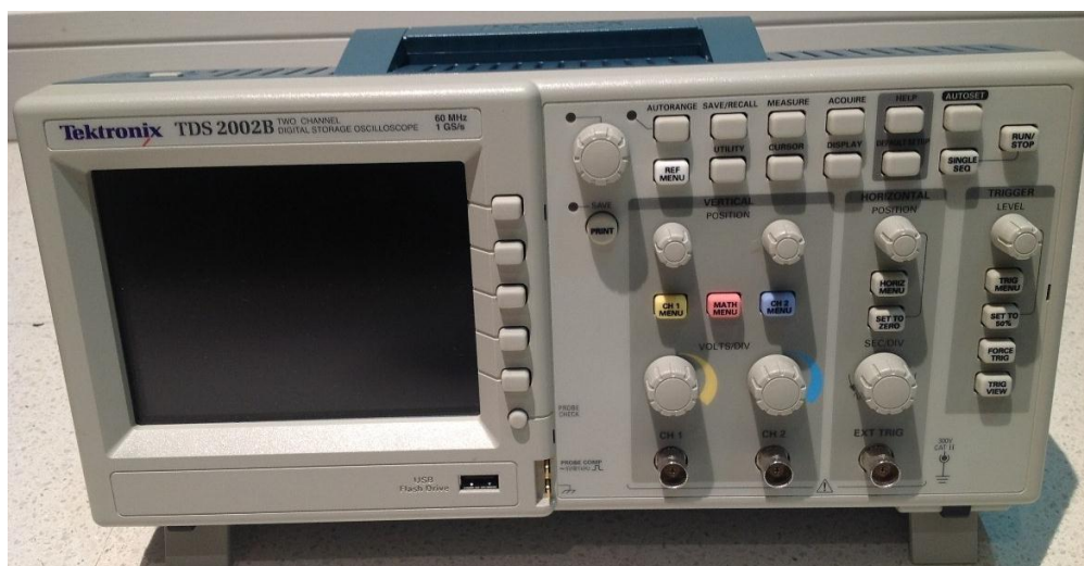
Figura 26. Foto do osciloscópio utilizado para medição de consumo energético
