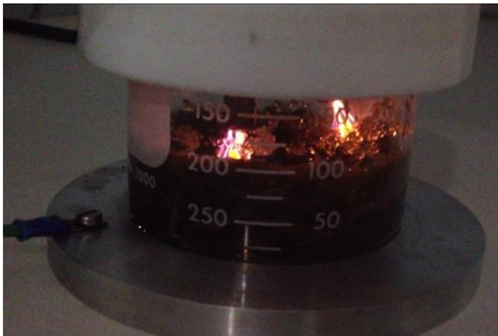
Figura 14. Reator de plasma DBD em funcionamento.
