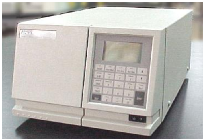
Figura 20. Foto do CLAE Waters com detector de UV.
