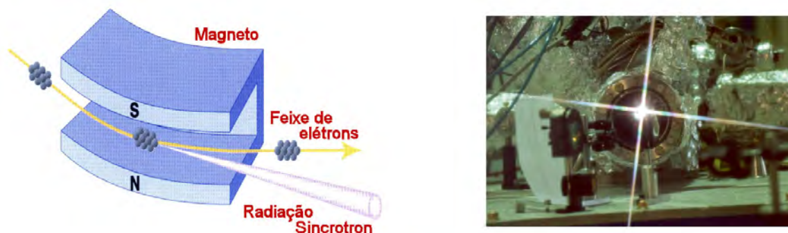
FIGURA 3.5: Ilustração do processo de emissão de radiação síncrotron por um elétron relativístico na presença de um campo magnético (esquerda). Luz síncrotron emitida através de uma janela (visor) em uma das linhas experimentais do LNLS (direita)
