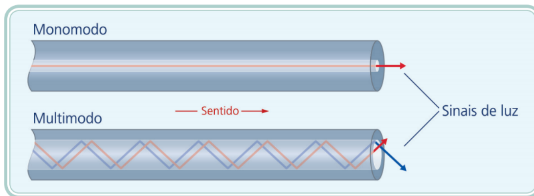
Figura 2.18: Propagação de sinal dentro da fibra óptica monomodo e multimodo, Fonte: CTISM
