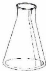
Erlenmeyer: Usado para titulações e aquecimento de líquidos.
