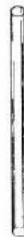
Vara de vidro: Usada para montagens de aparelhos, interligações e outros fins.
