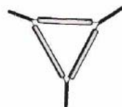
Triângulo de porcelana: Usado para sustentar cadinhos de porcelana em aquecimento no bico de Bunsen.
