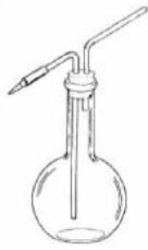
Frasco lavador: Usado para os mesmos fins da pisseta.
