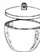
Cadinho de porcelana: Usado para aquecimentos à seco no bico de Bunsen e Mufla.
