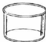
Cuba de vidro: Usada para banhos de gelo e fins diversos.
