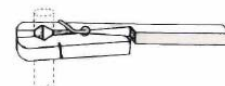
Pinça de madeira: Usada para segurar tubos de ensaio em aquecimento no bico de Bunsen.
