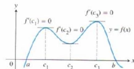
**FIGURA 3.11** O Teorema de Rolle diz que uma curva derivável tem ao menos uma tangente horizontal entre dois pontos quaisquer onde a curva cruza o eixo  $x$ . Essa curva tem três.
