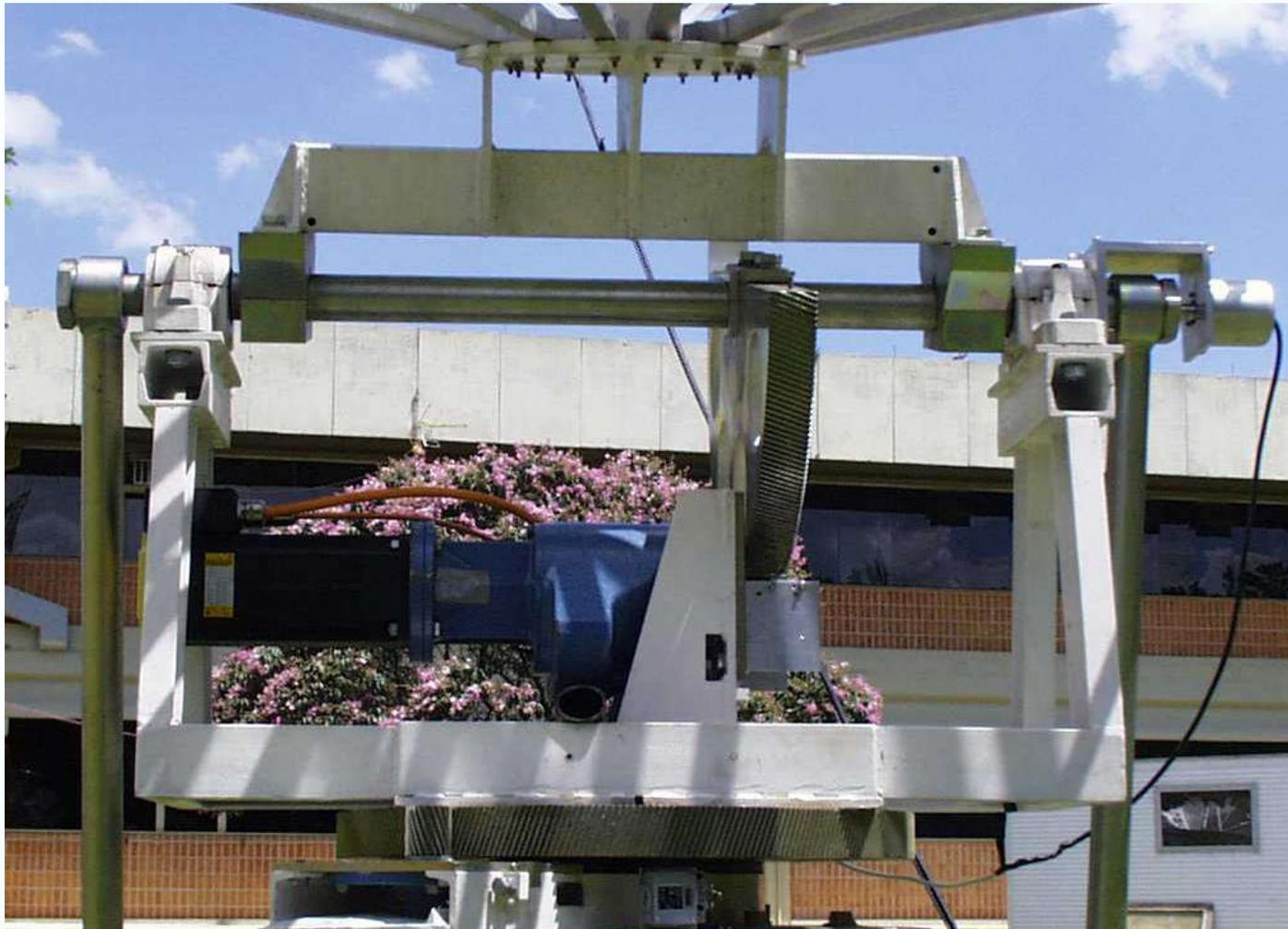
Parte superior da torre mostrando sistema para posicionamento em elevação.
