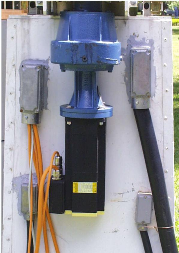
Parte posterior da torre mostrando o motor para movimento em azimute e conexões e cabos.
