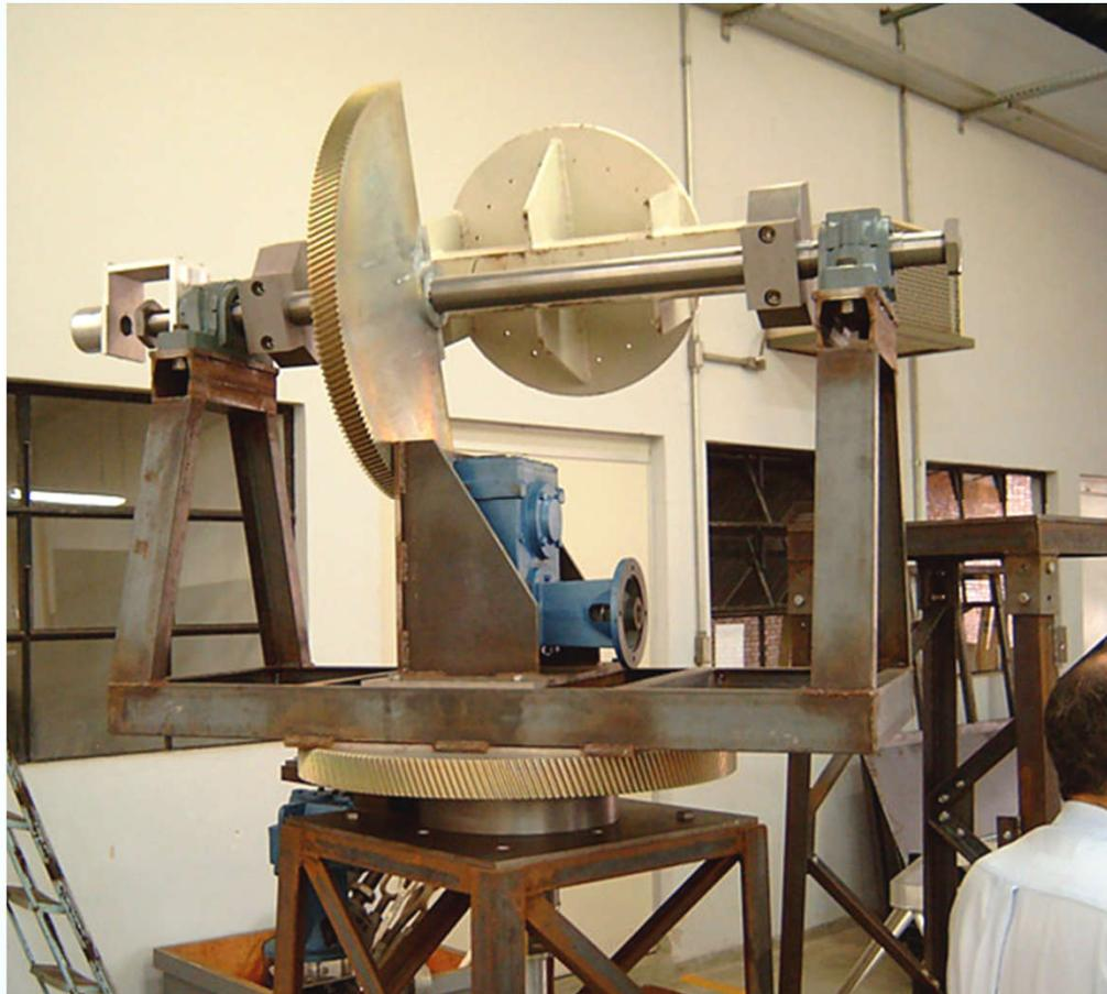
**Estrutura mecânica da antena de 4 m com montagem em altura e azimute**
